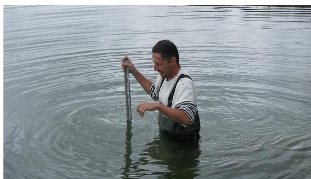
Figure 13 : Mesure des hauteurs d'eau et de vase avec une pige graduée (Photo F. Albert)
